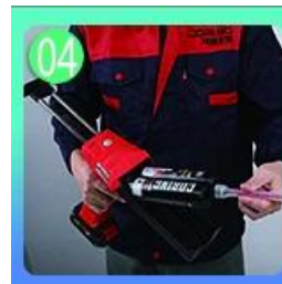
Tornilyo sa nozzle, ilagay sa grawt gun.
