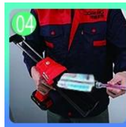
04 Tornilyo sa nozzle, ilagay sa grawt gun.
